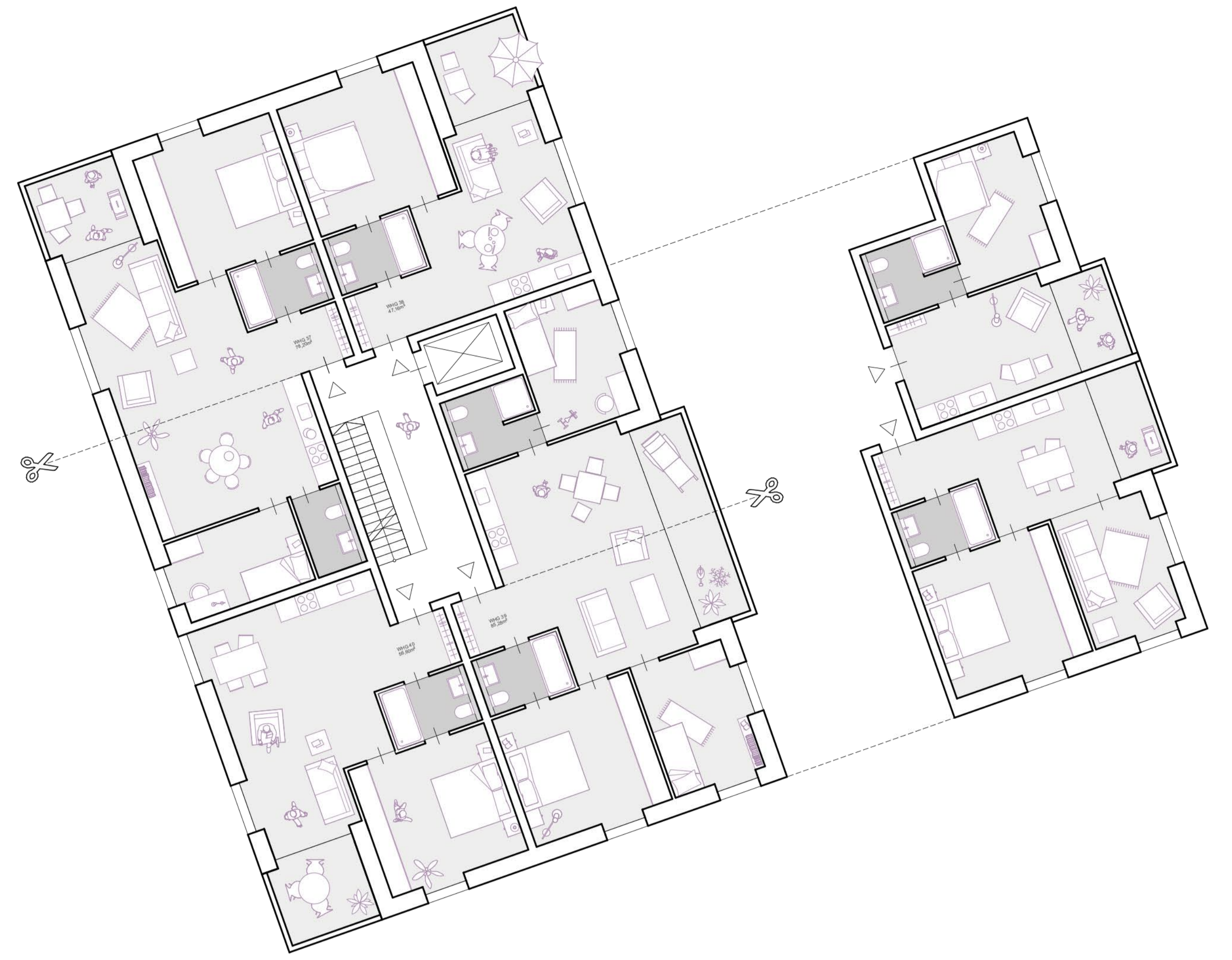
GRUNDRISS SEPERAT ERSCHLISSBAR 1-3. OBERGESCHOSS M 1:100
