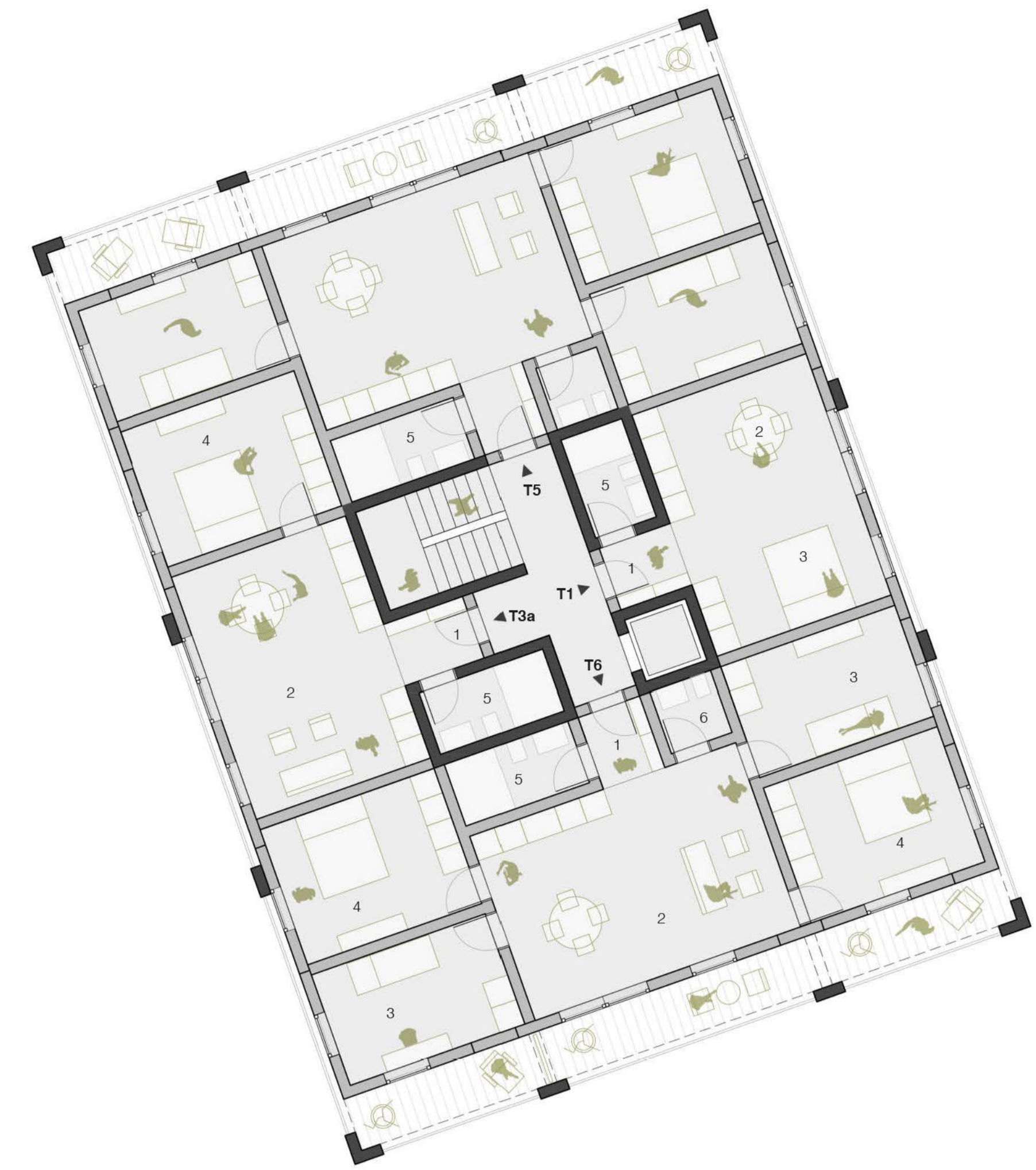
Nordgebäude Möblierter Grundriss M 1:100
